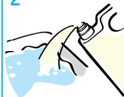
Adicionar uma embalagem (10L) de Suma Carbon Remover K21 à água do tanque.
